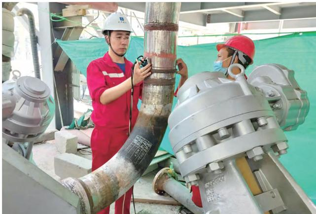
检测技术进行检测，相比传统“射线+超声波”探伤，它成像更立体，数据更详尽，且出图速度快，无污染物产生。
